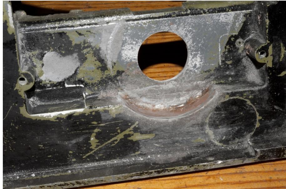
Les photos suivantes montrent le bâti terminé: on notera au passage que l'ouverture de la lampe veilleuse a été bouché.
