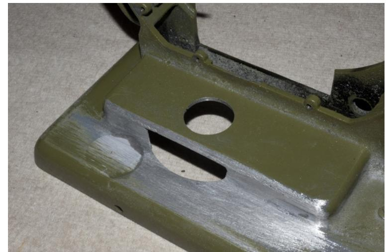
Une fois la découpe terminée, il fallait modifier le bossage pour masquer le trou. Pour cela j'ai prélevé une pièce du même matériau dans le socle inutilisé du Heurtier. L'ensemble a été collé à l'Araldite et mastiqué avec du Synthofer.
